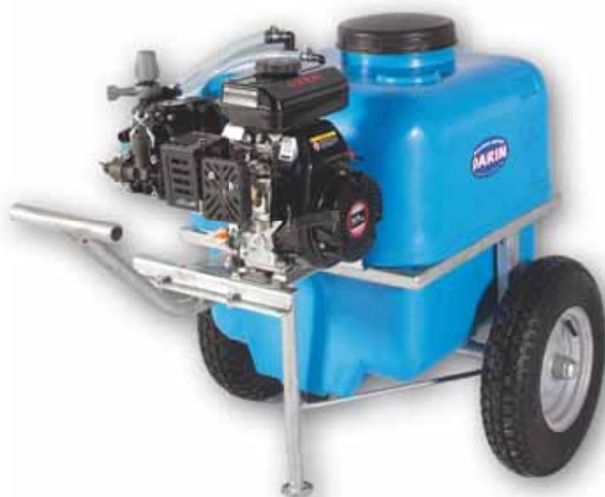
Carrellino lt. 100/200 con elettropompa o motopompa MC20/20
